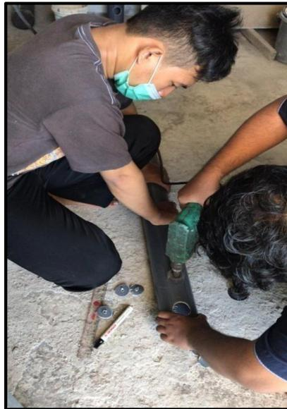
*Gambar II : proses pelubangan paralon untuk hidroponik*
