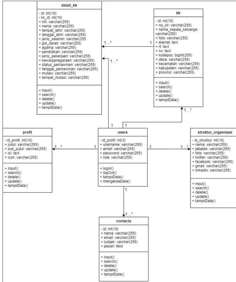
Gambar 3. Class Diagram Data Kependudukan
