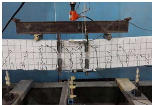
Gambar 13. Retak Lentur Balok Konvensional
