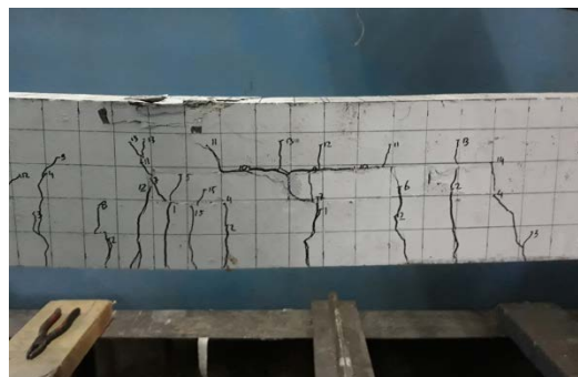
Gambar 14. Retak Lentur Balok IPBM
