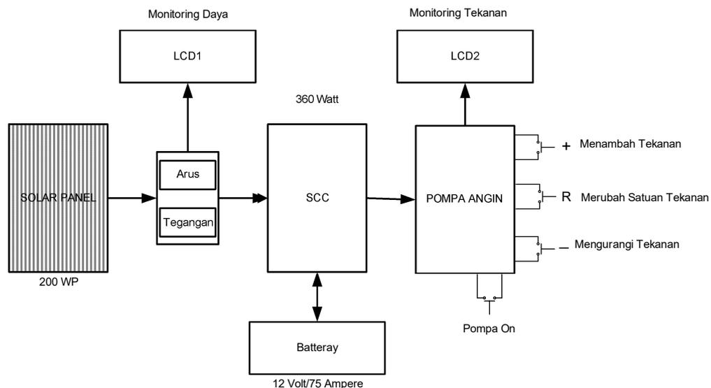
Gambar 4 Blok Diagram Peralatan Elektronik Rumah Pompa
